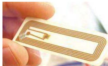
针对其物流特点, 可以通过在其货品上安装 RFID 标签来有效改善这一问题。RFID 利用射频技术来实现无线传输信号, 其最大的优点在于非接触, 并可实现批量读取和远程读取, 这样可以大大简化货品的识别过程。
